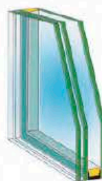
Vetro isolante e di sicurezza da mm 19 (6/7+9+4) per pannello da mm 24
