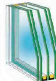
Vetro isolante e di sicurezza da mm 34 (6/7+9+4+9+6/7) per pannello da mm 40
